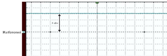
Gambar 11. Gelombang tegangan keluaran ZCS Buck Converter beban R 200 \Omega , D = 50 %, f = 25 kHz
