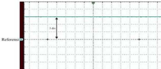
Gambar 14. Gelombang tegangan keluaran ZCS Buck Converter saat mencatu daya motor arus searah, D = 50\% , f = 25\text{ kHz}
