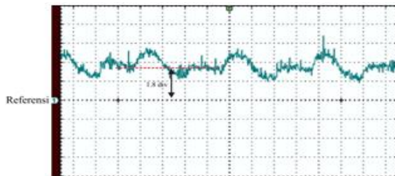
Gambar 15. Gelombang arus keluaran ZCS Buck Converter saat mencatu daya motor arus searah, D = 50\% , f = 25\text{ kHz}
