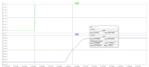
Gambar 6. Pengukuran tpdr dari divider
