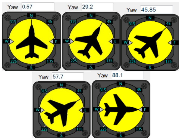
(f) Tampilan rotasi pengujian sudut yaw 0° hingga 90°
