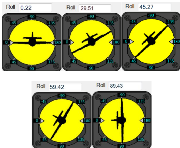
(f) Tampilan rotasi pengujian sudut roll 0° hingga 90°
