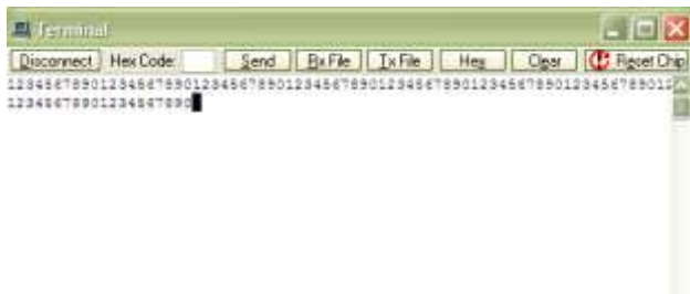
Gambar 16 Tampilan terminal pengujian transfer data karakter 0 – 9 secara wireless
