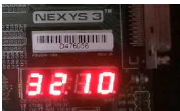
Gambar 7. Tampilan Counter Seven Segment pada Keadaan Reset atau Keadaan Awal.
