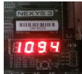
Gambar 9. Tampilan Counter Down Seven Segment pada Lajur Utara.
