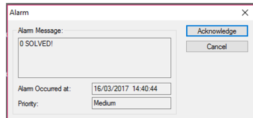
Gambar 11. Alarm box tampilan pada HMI.
