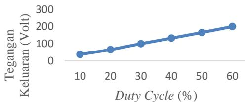
**Gambar 6. Grafik perbandingan tegangan keluaran dan *duty cycle* dengan beban lampu pijar 40W**
