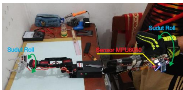
Gambar 12. Pembentukan sudut roll .
