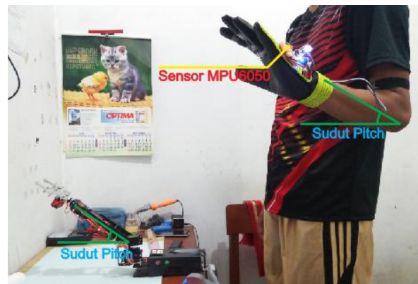
Gambar 10. Pembentukan sudut pitch .
