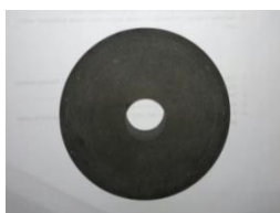
Gambar 5. Hasil isolator setelah proses bubut
