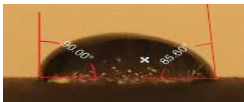
Gambar 6. Sudut kontak permukaan isolator kondisi halus
