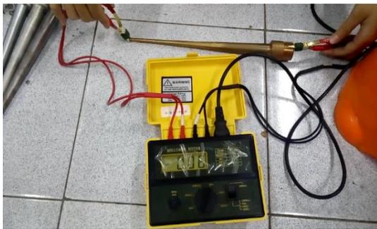
Gambar 4. Pengukuran Resistansi Menggunakan MiliOhm Meter
