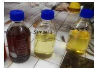
Gambar 15. Pengujian warna sebelum purifikasi
