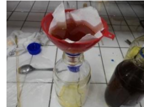
Gambar 7. Penyaringan minyak isolasi
