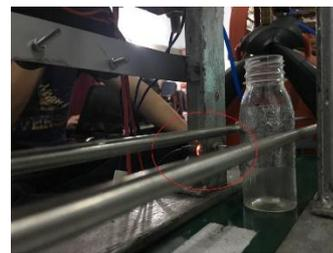
Gambar 7 Botol Dideteksi pada Filling stations.
