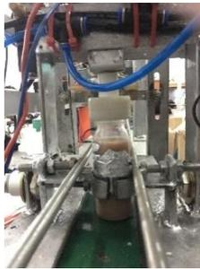
Gambar 9 Botol Dideteksi pada Capping Stations.
