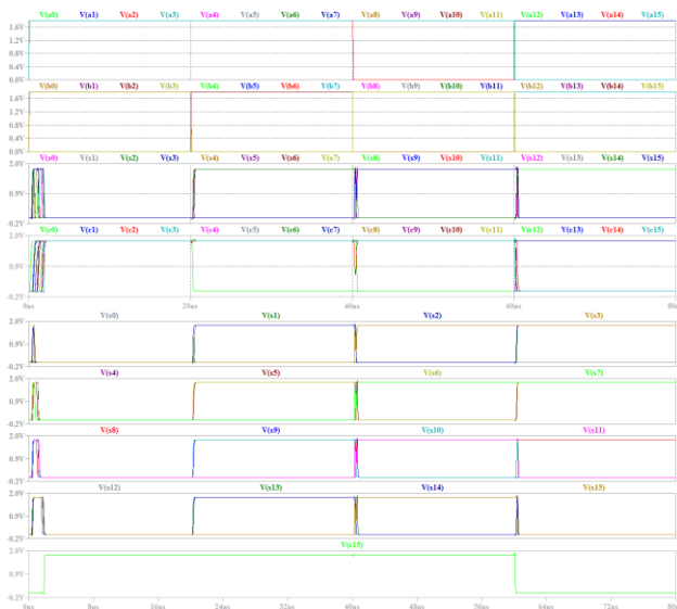
Gambar 23. Pengujian fungsional CLA 16-bit menggunakan CLA 4-bit
