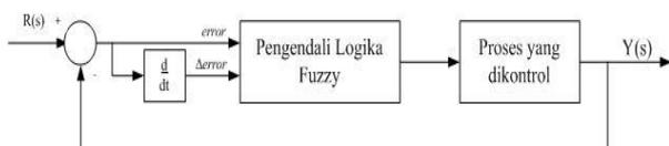
Gambar 1. Sistem loop tertutup dengan pengendali Fuzzy
