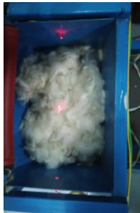
Gambar 10. Sensor terhalang kapas.
