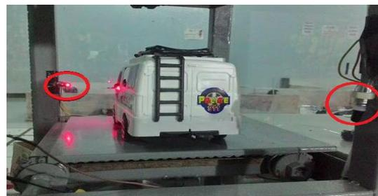
Gambar 8. Pengujian sensor photodiode saat terhalang mobil
