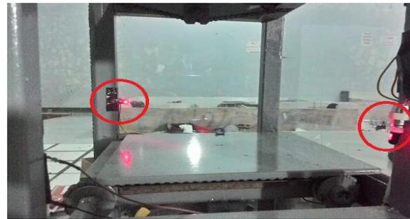
Gambar 7. Pengujian sensor photodiode saat tidak terhalang mobil
