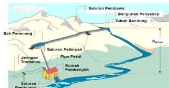
Gambar 1 skema prinsip kerja PLTMH
