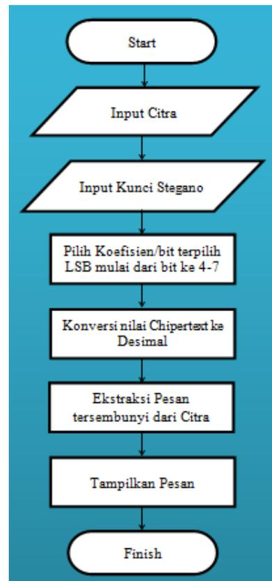
Gambar 3.3 Flowchart untuk proses pengestrakan teks yang ada dalam gambar
