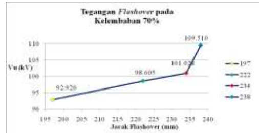
Gambar 7 Grafik tegangan flashover dengan jarak flashover pada kelembaban 70%
