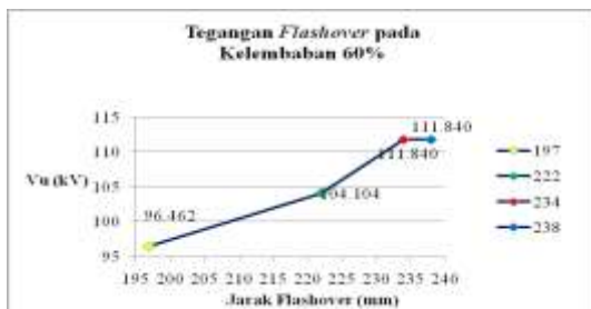
Gambar 6. Grafik tegangan flashover dengan jarak flashover pada kelembaban 60%
