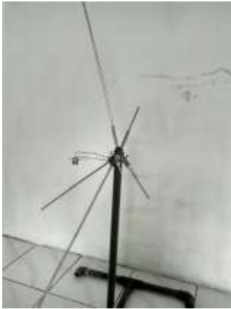
Gambar 2. Hardware antenna V-Vertical Groundplane lengkap dengan penyangganya
