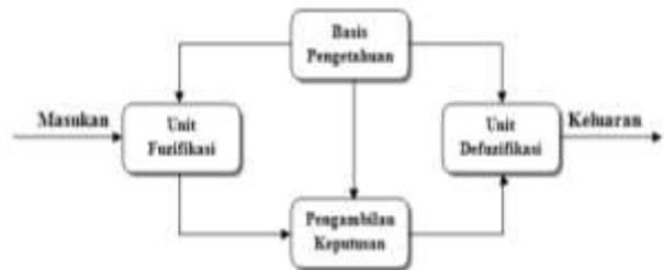
Gambar 5. Struktur dasar pengendali fuzzy<sup>[9]</sup>
