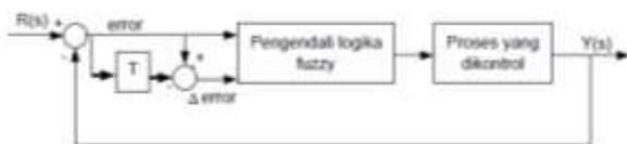
Gambar 4. Sistem loop tertutup dengan pengendali fuzzy
