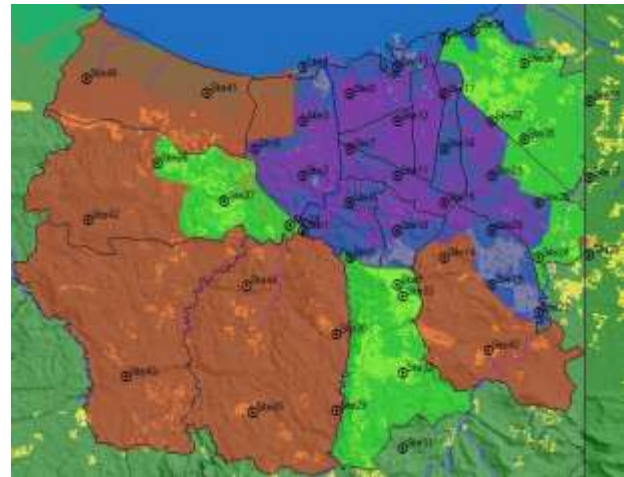
Gambar 6. Peletakan eNodeB Perencanaan Kapasitas
