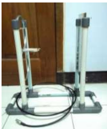
Gambar 6. Fabrikasi antena dual circular loop lengkap dengan penyangganya
