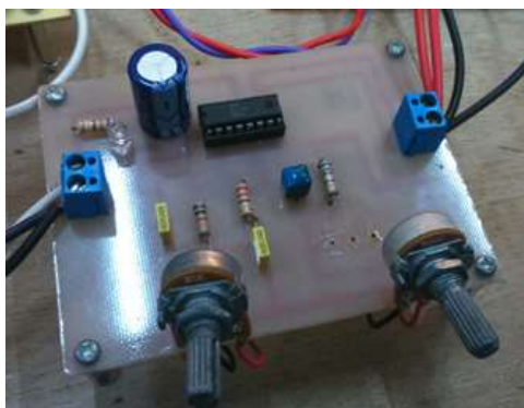
Gambar 4. Realisasi rangkaian IC TL494
