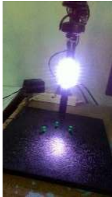
Gambar 2. Alat akuisisi citra telapak tangan
