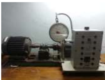
Gambar 9. Motor 3 fasa yang terkopel dengan generator DC
