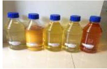
Gambar 2 Sampel Minyak Isolasi Transformator
