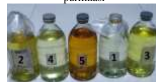
Gambar 26 Warna sampel minyak isolasi transformator setelah purifikasi
