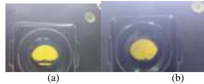
Gambar 24 Skala warna minyak isolasi transformator pada sampel 4 (a) sebelum purifikasi, dan (b) setelah purifikasi
