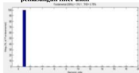
Gambar 17. Spektrum frekuensi tegangan sumber setelah pemasangan filter aktif
