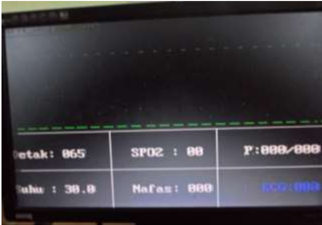
Gambar 13 Pengujian komponen sinkron VGA
