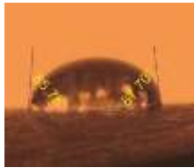
Gambar 9 Sudut Kontak permukaan Isolator polimer resin epoksi silika Polutan Air Hujan
