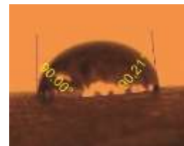
Gambar 8 Sudut Kontak permukaan Isolator polimer resin epoksi silika Polutan Industri
