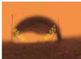
Gambar 6 Sudut Kontak permukaan Isolator polimer resin epoksi silika Polutan Pantai
