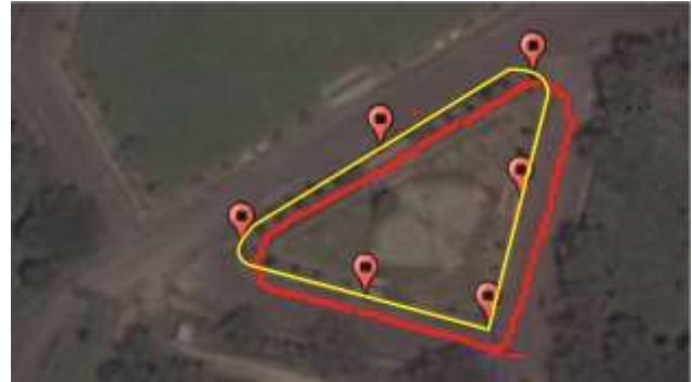
Gambar 10. Pengujian GPS sebagai sensor posisi
