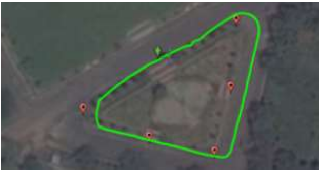
Gambar 12. Pengujian GPS sebagai sensor posisi
