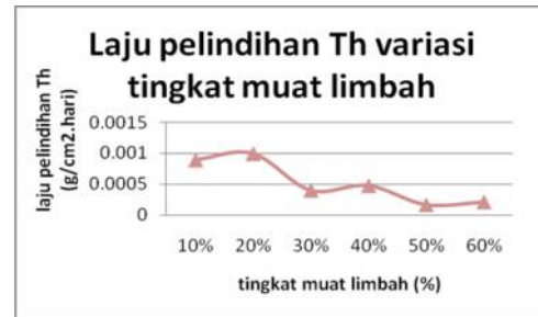
Gambar 13. Grafik Laju Pelindihan Unsur Thorium pada Blok Synroc Limbah Variasi Tingkat Muat Limbah
