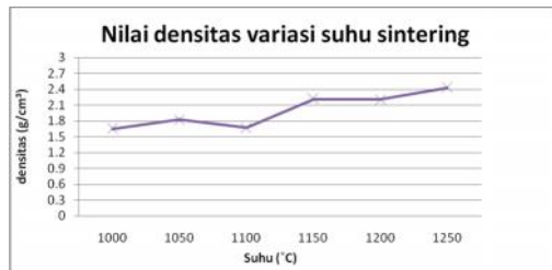
Gambar 2. Grafik Nilai Densitas Blok Synroc Limbah Variasi Suhu Sintering
