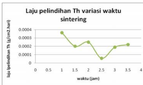
Gambar 9. Grafik Laju Pelindihan Unsur Thorium Pada Blok Synroc Limbah Variasi Waktu Sintering
