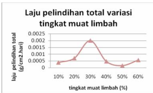
Gambar 12. Grafik Laju Pelindihan Total Blok Synroc Limbah Variasi Tingkat Muat Limbah
