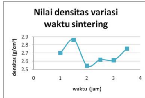
Gambar 6. Grafik Densitas Blok Synroc Limbah Variasi Waktu Sintering
