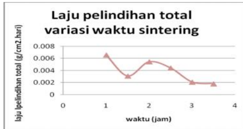
Gambar 8. Grafik Laju Pelindihan Total Blok Synroc Limbah Variasi Waktu Sintering
