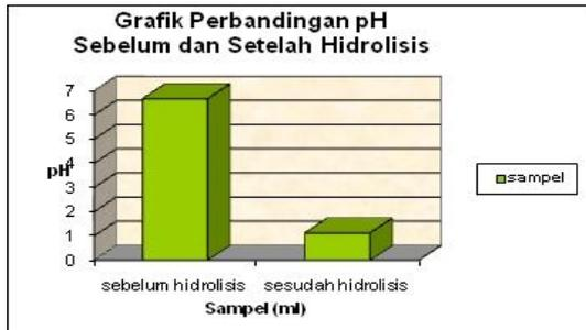
Berdasarkan gambar di atas, terjadi penurunan nilai pH sampel setelah dihidrolisis. pH yang semula 6,68 turun menjadi 1,13. Hal ini disebabkan karena proses pemecahan zat pati (hidrolisis) menggunakan asam kuat HCl. Penambahan asam akan mempengaruhi pH (Machbubatul, 2008).
