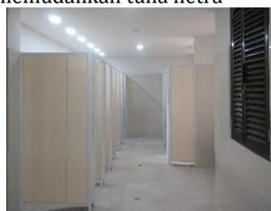
Bahan material yang digunakan untuk lantai tidak licin, Pintu pada toilet tergolong mudah untuk dibuka dan ditutup. Kunci grendel juga telah disesuaikan untuk memungkinkannya dibuka. Di sekitar pintu masuk tidak terdapat *emergency sound button* untuk mencegah hal yang buruk terjadi
