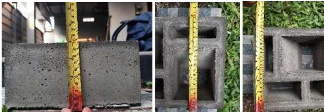
**Gambar 8.** Pengukuran fisik/visual pada roster
