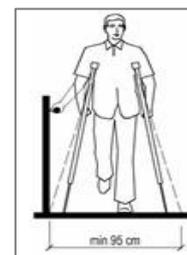
Gambar ruang pergerakan untuk pengguna kruk ke samping (Source: Permen PUPR Nomor 30/PRT/M/2006)
