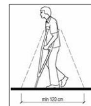
Gambar ruang gerak bagi pengguna kruk ke depan (Source: Permen PUPR Nomor 30/PRT/M/2006)
