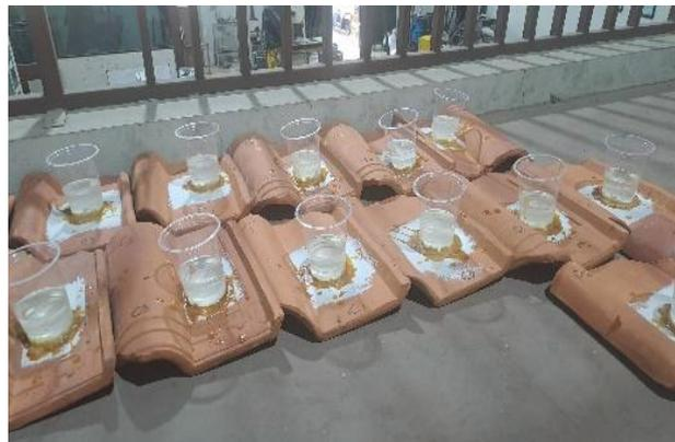
**Gambar 8.** Pengujian rembesan air
