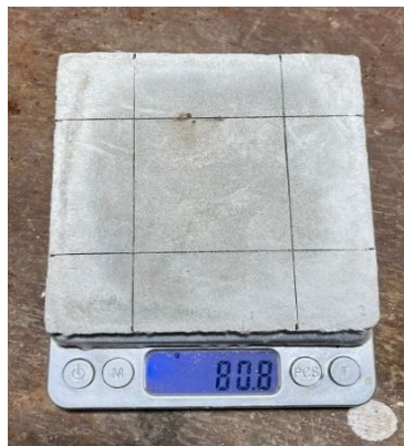
Gambar 2. Uji kerapatan benda uji
