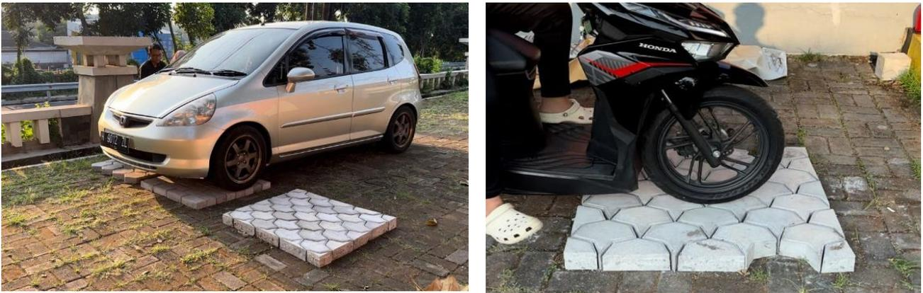
**Gambar 3.** Pengujian *interlocking paving block* menggunakan kendaraan bermotor
