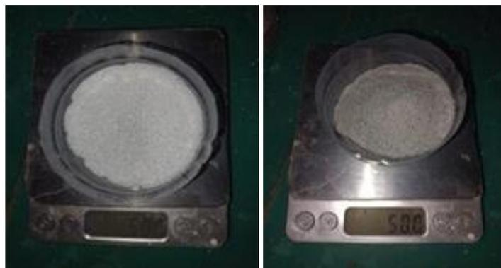
Gambar 5. Pembuatan lapis glass bead limbah kaca
