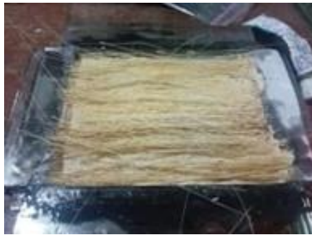
Gambar 4. Penyusunan serat daun nanas di atas adonan gypsum
