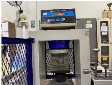
Gambar 1. Uji Kuat Tekan
