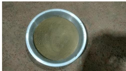
Gambar 2. Fly-ash lolos saringan 0,075 mm
