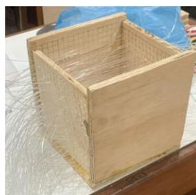
**Gambar 3.** Cetakan beton transparan
