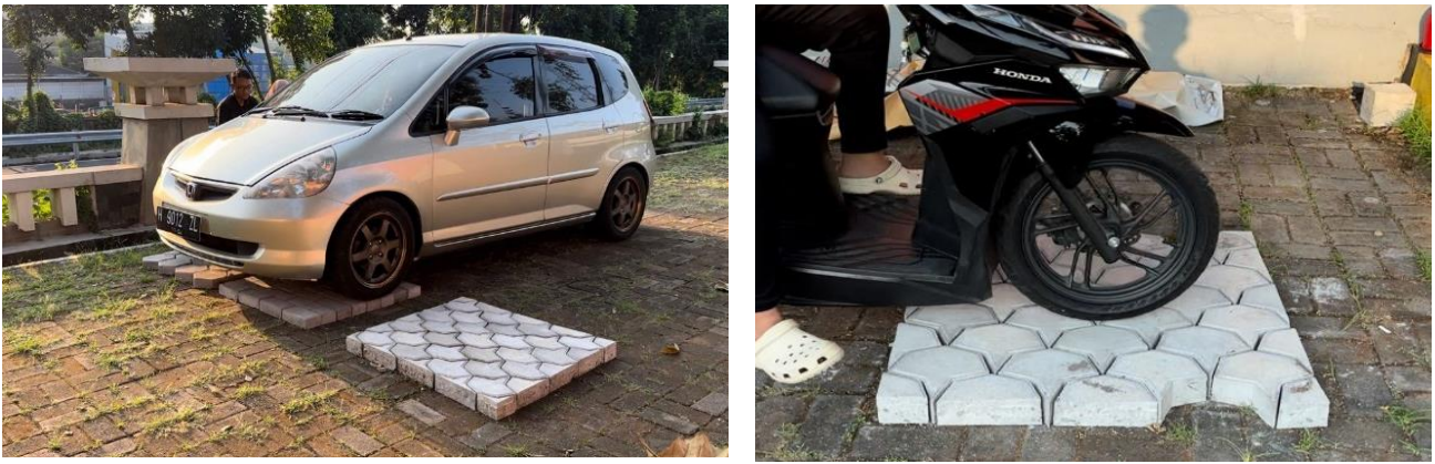
Gambar 3. Pengujian interlocking paving block menggunakan kendaraan bermotor
