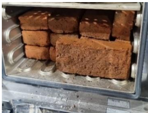
Gambar 3. Proses pengujian daya serap air
