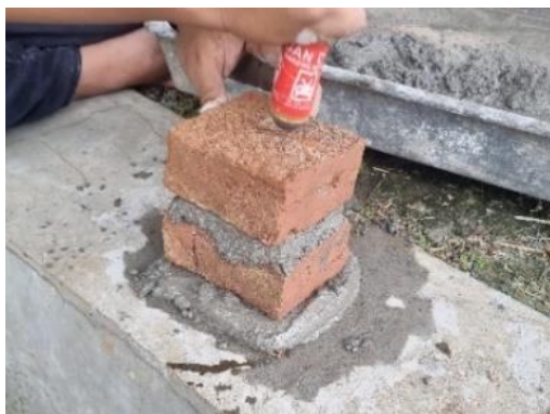
Gambar 4. Proses pembuatan benda uji untuk proses pengujian kuat tekan
