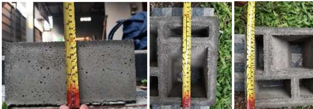
Gambar 8. Pengukuran fisik/visual pada roster
