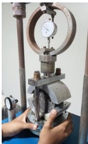
Gambar 3. Pengujian marshall test
