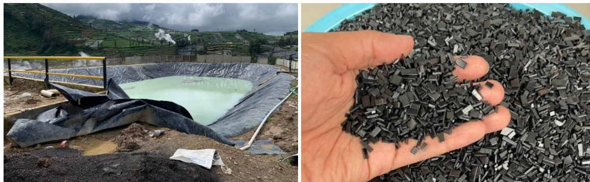
Gambar 1. Lembaran dan Cacahan Geomembrane (HDPE)
