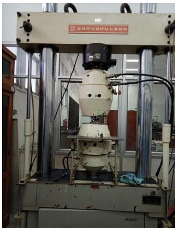
Gambar 4. Mesin Uji Tarik
