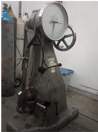
Gambar 5. Mesin Uji *Impact*
