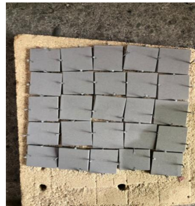
Gambar 4. Hasil Sandblasting spesimen uji dengan tingkat kebersihan SA 3
