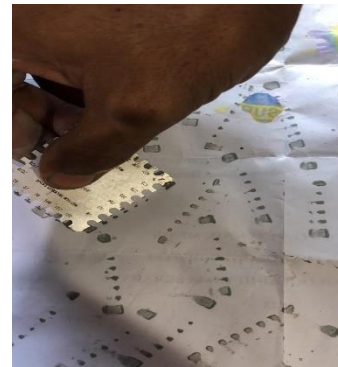
Gambar 6. Proses Pelaksanaan Pengukuran WFT Menggunakan Wet Film Comb
