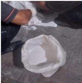
Gambar 2. Material Abrasif *Steel Grit* sebagai bahan *sandblasting*
