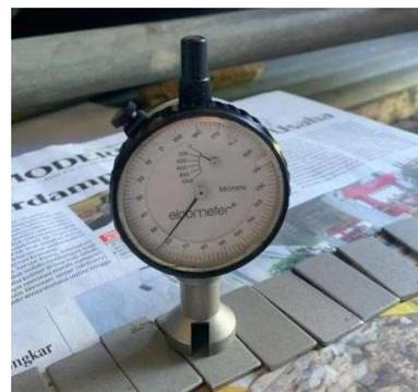
Gambar 4. Pengujian Kekasaran Spesimen ST 42
