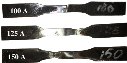
Gambar 10. Bentuk Patahan Spesimen Tarik
